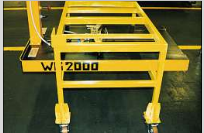
WGRB 2000 Verktögsställ för max. 2 ton WGRB 2000 Die rack for max. 2 tons WGRB 2000 Werkzeuggestell für max. 2 ton
