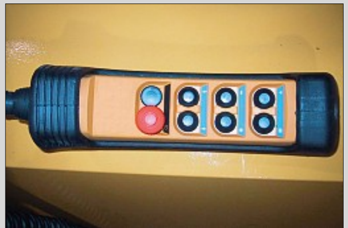
Kontroll av åk, lyft och knuff/drag Control of drive, lift and push/pull Fahrt-, Hebe- und Zug/Schubkontrolle
