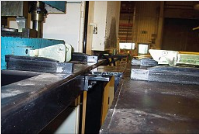
Verktygskrok och autokrok system Die hook and auto hook system Werkzeughaken und automatischer Haken
