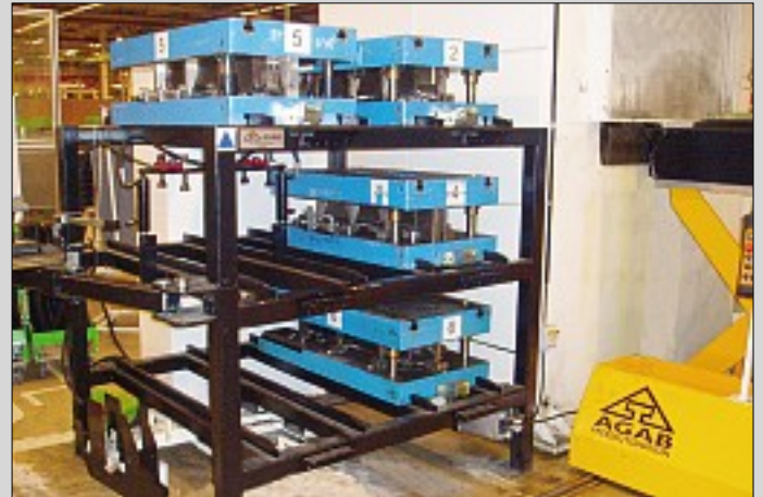
Verktygsställ i tre nivåer och räls för vagn Rack in three levels and rail for die cart Gestell mit drei Ebenen und Gleis für den Wagen
