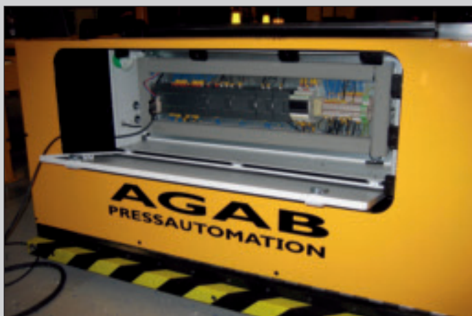
PLC för fullautomatisk verktygsväxling PLC for full automation of die changing SPS für Vollautomation Werkzeugwechsel
