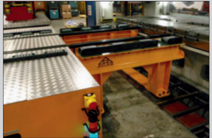
2 m fast överbrygning vagn/press 2 m fix bridge die cart/press 2 m feste Überbrückung Wagen/Presse
