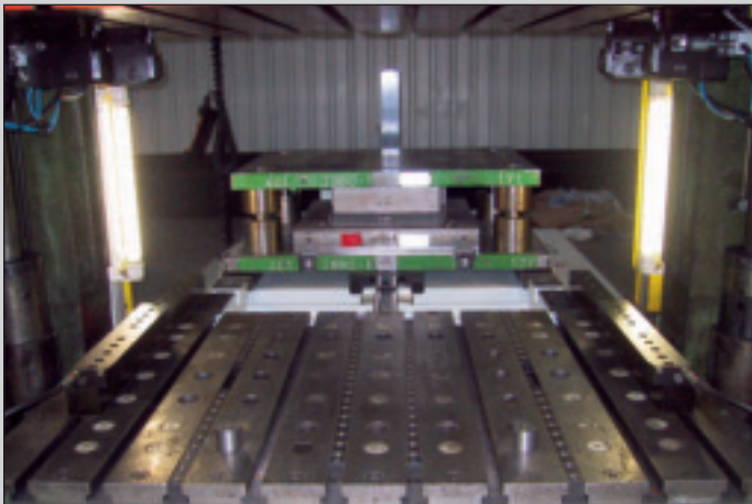
Automatisk spänning med positionering Automatic clamping with line up Automatisches Spannen mit Positionierung
