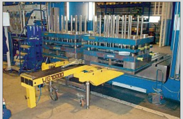
Konsoler med WG 10000 knuff/drag adapter ROLL ARMS in use with WG 10000 push/pull unit Werkzeugträger mit Werkzeugwechseladapter WG 10000
