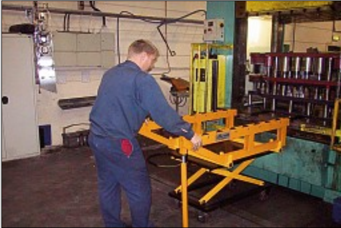
Enkelt att placera konsoler med rullvagn Easy positioning of the arms by the scissor carrier Einfache Montage mittels Rollwagen
