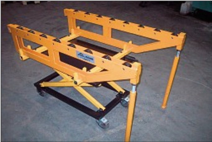
Rullvagn för transport av konsoler Scissor lift-off carrier for transporting the ROLL ARMS Mobiler Rollwagen zum Transport der Werkzeugträger
