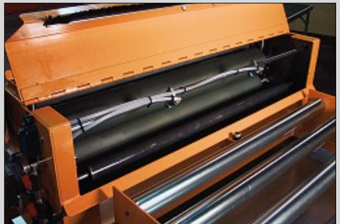
Högtrycksmunstycke för jämn och exakt dosering High pressurized nozzles for exact spraying Hochdruckdüsen für exakte Dosierung
