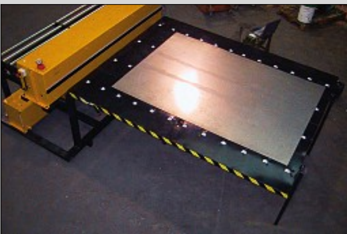
MLM motordriven 2m ämnessmörjare med vikbart bord MLM motorized 2m lubricator with folding table MLM motorisierter 2m Tafelbefetter mit Rollenfalttisch
